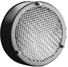
ハニースポット (L) [025500] 180φ 照射角20～ 25° レフ用 ※ハロゲンランプは100W以下をご使用ください。 金属部分の発熱で火傷するおそれがあります。
