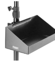
ボーエンス電源台 [232520] 電源台内寸: 365(w)×175(d)×138(h)mm 重量: 2.7kg 取付可能パイプ径: φ30~40mm 耐荷重: 15kg
