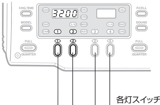
●出力コネクター①②にヘッドを接続して、各灯スイッチ①②を「ON」している状態の出力表示。1600Ws 2灯が発光します。
