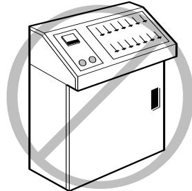
■調光機に接続しての使用はしないでください。本機および調光機を破損する恐れがあります。
