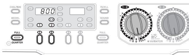
※図の出力設定は出力コネクター①②を使用し、出力モードの「QUARTER」を選択しています。
