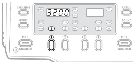
●出力コネクター①②にヘッドを接続して、各灯スイッチ②を「OFF」している状態の出力表示。①のヘッドは3200Wsで発光します。
