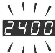
調光操作で出力を下げた場合又は色温度や閃光スピードを下げた場合には出力表示が点滅します。テスト発光スイッチを押し、一度発光させてください。充電が完了すると設定された出力光になります。
