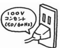
■ACコードプラグやヘッドコードプラグを着脱する時は必ず電源部のメインスイッチ、モデリングランプスイッチを切ってください。
