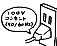
■ACコードプラグやヘッドコードプラグを着脱する時は必ず電源部のメインスイッチ、モデリングランプスイッチを切ってください。
