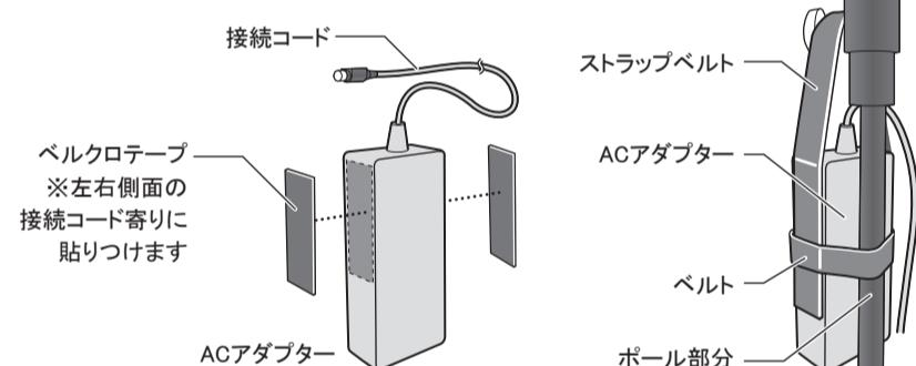
【ご注意】 落下防止のため、付属のベルトでACアダプター本体をポール部分に固定してください。
